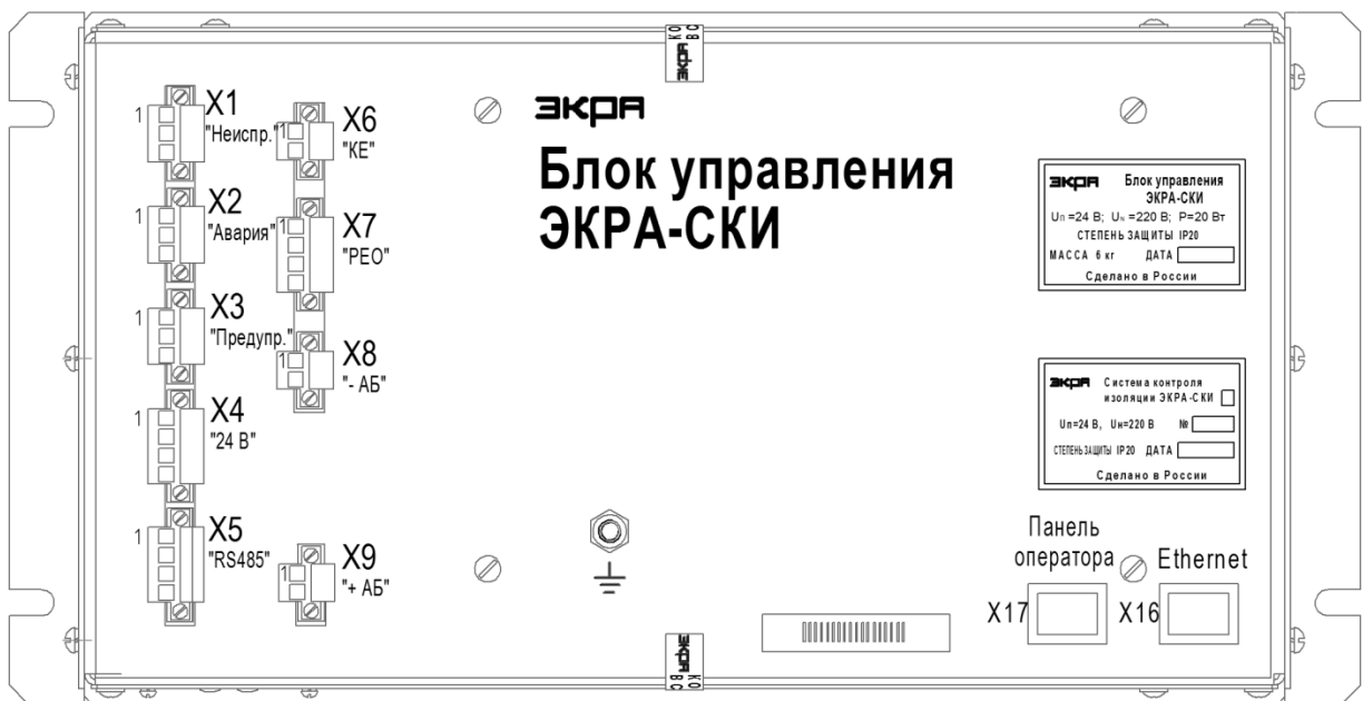
Рисунок В.4 – Общий вид блока управления ЭКРА-СКИ
